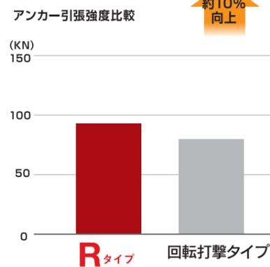
※試験条件: アンカーボルトM16 埋込深さ130mm(グラフ①②) 埋込深さ110mm(グラフ③)
