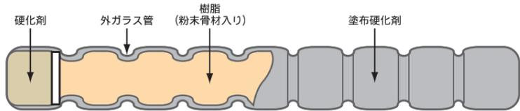
変性ビニルエステル樹脂を採用し、硬化剤をガラス管頭部に収容し更に外側にコーティングした打込み式のカプセル型固着剤です。
