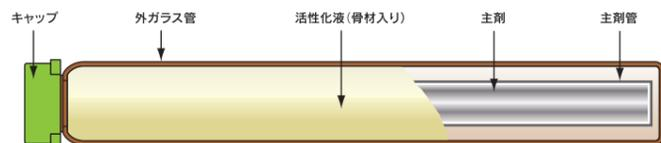
無機質のセメント系主剤とペースト化した活性化液を一定比率でガラス管容器に収容した無機系の接着系アンカーです。耐熱性に優れ、揮発性有機化合物(VOC)13品目を含まない環境に優しいカプセル型固着剤です。
