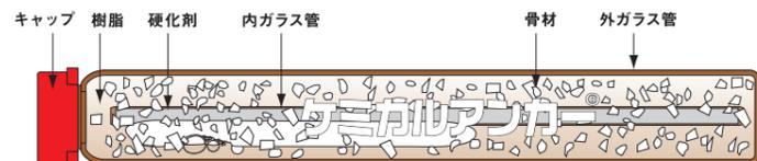
変性ビニルエステル樹脂を採用し、骨材と硬化剤をガラス管内に収容したカプセル型固着剤です。
